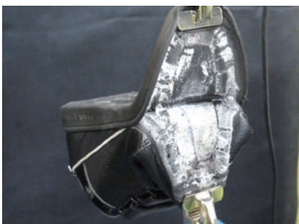
はく離抵抗試験
